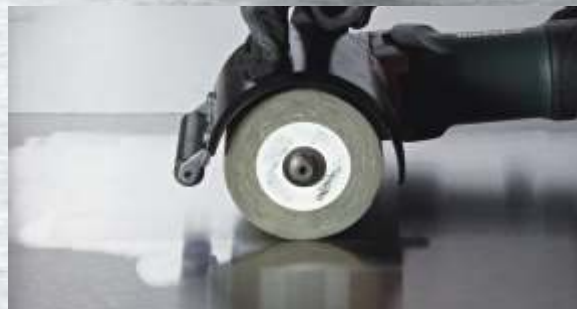
Satynowy szlif: idealnie gładkie powierzchnie dzięki zastosowaniu gumowego wałka (satynowanie).
