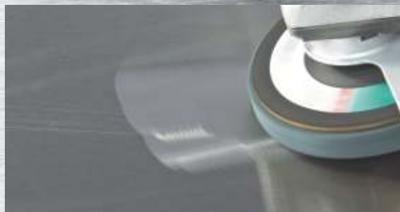
Usuwanie zadrapań: za pomocą niskoobrotowej szlifierki kątowej INOX oraz tarczy szlifującej ze sprasowanej włókniny.
