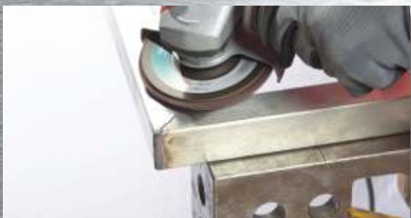
Szlifowanie spoin spawalniczych: za pomocą niskoobrotowej szlifierki kątowej INOX oraz lamelowo-włókninowej tarczy szlifierskiej o średniej ziarnistości.
