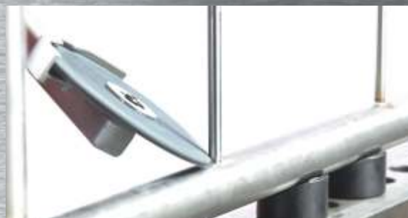
Usuwanie nalotów spawalniczych: naloty spawalnicze nie tylko nieładnie wyglądają, ale prowadzą także do utleniania. Można je łatwo usunąć stosując szlifierkę do spoin.
