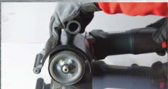
Przygotowanie do polerowania: za pomocą wałka rozprężnego oraz taśmy szlifierskiej PYRAMID o ziarnistości P 2000 (A6).
