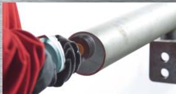
Usuwanie pozostałości po cięciu: szlifierka prosta idealnie nadaje się do szlifowania krawędzi rur po cięciu.
