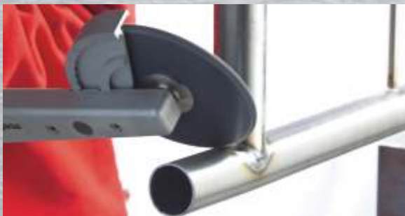
Szlifowanie spoin spawalniczych w narożnikach: dzięki wyjątkowo płaskiej konstrukcji szlifierka KNSE 12-150 idealnie nadaje się do szlifowania spoin pachwinowych, także w trudno dostępnych miejscach.
