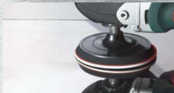
Polerowanie na wysoki połysk: przy zastosowaniu polerki kątowej PE 12-175 oraz tarczy filcowej i niebieskiej pasty do polerowania.
