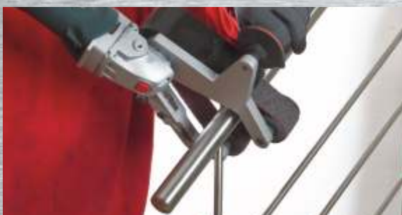
Usuwanie zadrapań: szlifierka taśmowa do rur RBE 12-180 pomoże w szybkim i efektywnym usunięciu zadrapań z rur o różnych średnicach.
