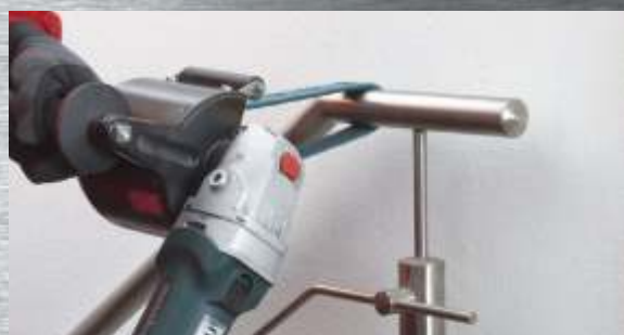
Usuwanie lekkich zadrapań i zabrudzeń nawet w trudno dostępnych miejscach: satyniarka uzbrojona w taśmę z włókna to jedno z wielu zastosowań tego wszechstronnego urządzenia.
