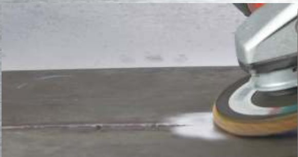
Zgrubne szlifowanie spoin spawalniczych: przy zastosowaniu niskoobrotowej szlifierki kątowej INOX i lamelowo-włókninowej tarczy szlifierskiej o dużej ziarnistości.
