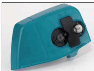
T L C beznarzędziowy naciąg łańcucha.
