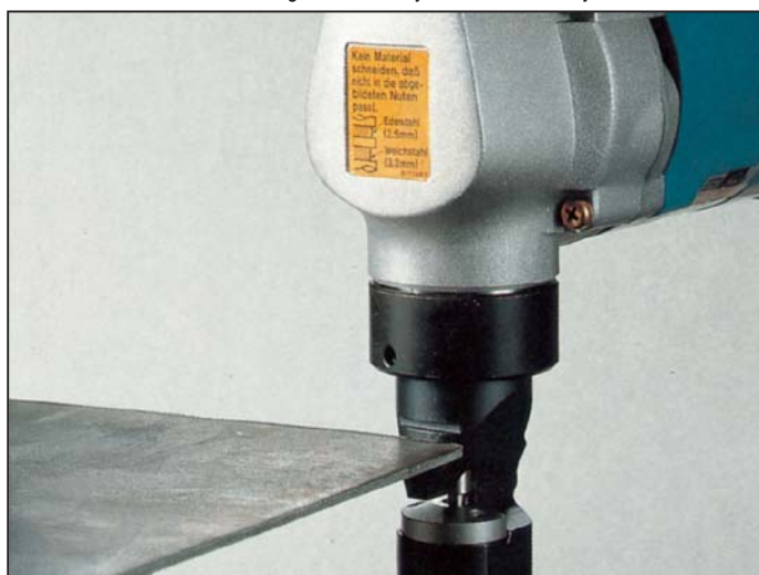
Pomiar grubości blachy rowkiem mierniczym JN1601 i JN3200
